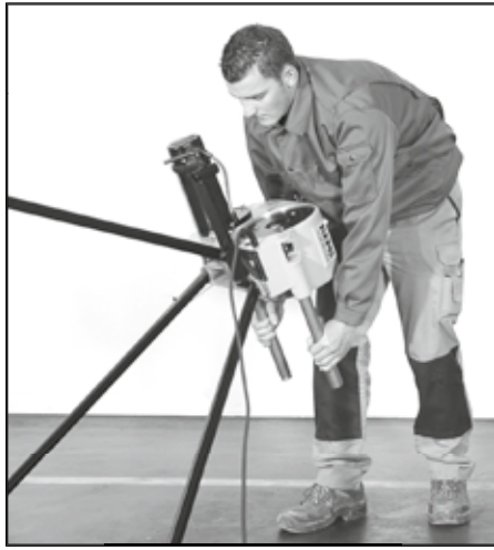
Fig. 2: Aufstellen der Maschine Fig. 2: Putting up the machine Fig. 2: Pose de la machine Fig. 2: Raddrizzamento della macchina Fig. 2: Instalación de la máquina Fig. 2: Plaatsen van de machine Fig. 2: Uppställning av maskinen Fig. 2: Oppstilling av maskinen Fig. 2: Opstilling af maskinen Kuva 2: Koneen pystytys Fig. 2: Instalação da máquina Rys. 2: Ustawianie maszyny Obr. 2: Stroj postaviti Obr. 2: Stroj postaviti 2. ábra: Felállítani a gépet Sl. 2: Postavljanje stroja Sl. 2: Postavljanje mašine Slika 2: Postavitev stroja Fig. 2: Amplasarea maşinii Фиг. 2: Установка станка Εικ. 2: Τοποθέτηση της μηχανής Resim 2: Makinenin kurulumu Фиг. 2: Монтаж на машината 2 pav.: Staklių pastatymas Att. 2: Mašinas uzstādīšana Joonis 2: Masina ülespanek
