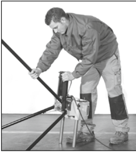
Fig. 1: RohrfüÙe einstecken Fig. 1: Inserting the tubular legs Fig. 1: Engager les pieds tubulaires Fig. 1: Infilare le gambe di supporto Fig. 1: Introducir las patas tubulares Fig. 1: Steunpoten insteken Fig. 1: Isättning av benen Fig. 1: Montering av rørben Fig. 1: Indstikning af rørben Kuva 1: Putkijalkojen asennus Fig. 1: Introduzir os pés tubulares Rys. 1: Monta¿ noków rurkowych Obr. 1: Trubkové nohy nastrčit Obr. 1: Rúrkové nohy nastrčit 1. ábra: Feltolni a csölábakat Sl. 1: Utaknuti noge od cijevi Sl. 1: Umetanje no¿ica cevi Slika 1: Vstavite cevno podno¿je Fig. 1: Introducere a picioarelor tubulare Фиг. 1: Вставить трубные ножки Εικ. 1: Τοποθέτηση των σωληνωτών ποδιών Resim 1: Boru tipi ayakların takılması Фиг. 1: Поставяне на тръбните стойки 1 pav.: Vamzdinių kojų įstatymas Att. 1: Ievietot caurules galus Joonis 1: Torujalgade sissepanek
