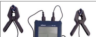
Abb. 4: Anschluss der Temperaturzangen
