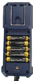
Fig. 16: Achterkant van de besturingseenheid met geopend batterijvak
