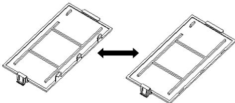
2. Installare la scheda PCB dell'interfaccia. Spingere sui piedini e fissarla con le 4 viti.
